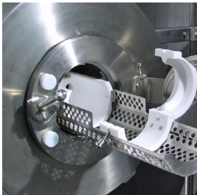
Rys. 1. Ręczny układ manipulacyjny do sterylnego transferu z zastosowaniem systemu DPTE, widziany od środka izolatora.
