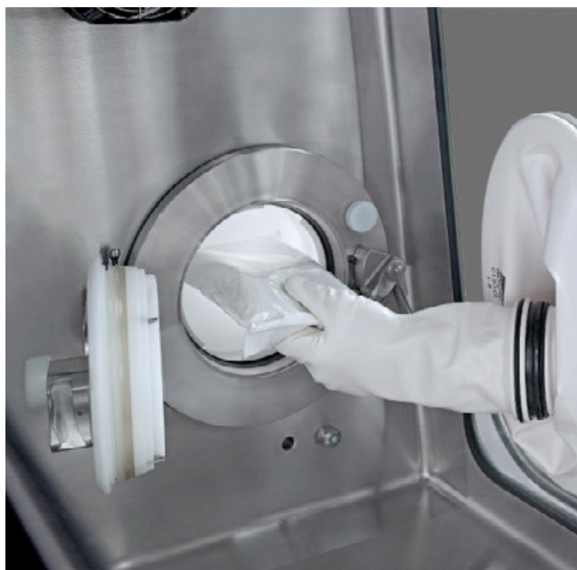
Rys. 1. Ręczny układ manipulacyjny do sterylnego transferu z zastosowaniem systemu DPTE, widziany od środka izolatora.
